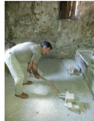
43. Podizač kojim se reguliše finoća mljevenja – A regulator of the fineness of grinding Heber zur Regulierung der Feinheit des Mahlens
