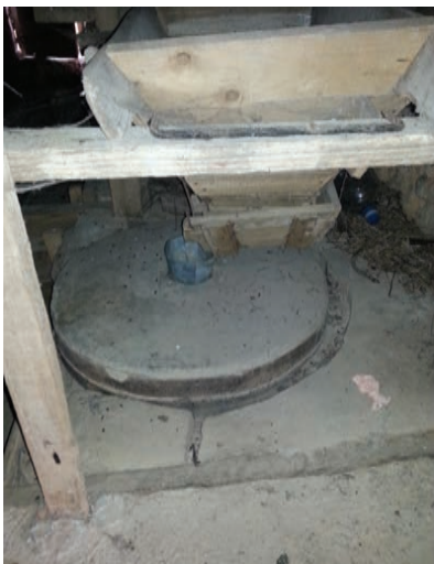
104. Ušljebrka mlin – koš sa kamenim kolom – Ušljebrka watermill – a basket with a stone circle Ušljebrka-Mühle – Korb mit Steinrad
